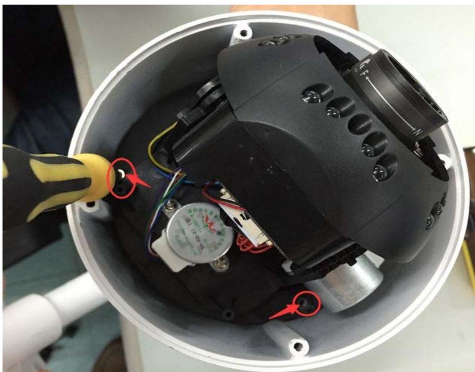
**Paso 3:** : Tras retirar estos tres tonillos mueva la lente despacio para evitar los cables del interior puedan romperse. Observará la ranura memoria micro SD en un lateral de la placa.
