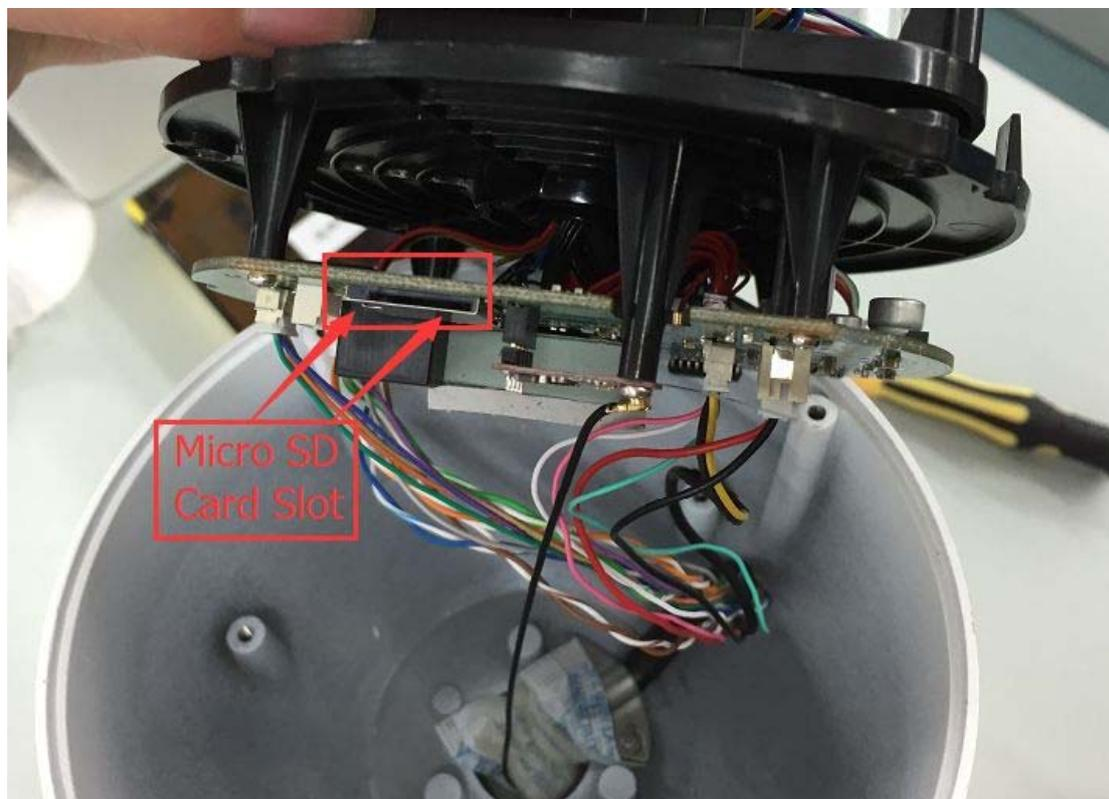
**Nota :** Para evitar dañar la cámara verifique atornillar correctamente la cámara , ya que en caso contrario la lente puede rayarse al moverse en el interior de la cámara.
