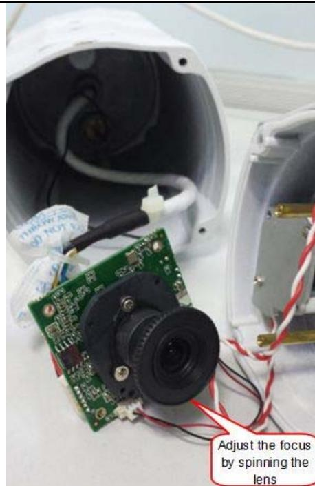
**Paso 6:** Vuelva a montar la cámara con el enfoque ajustado.
